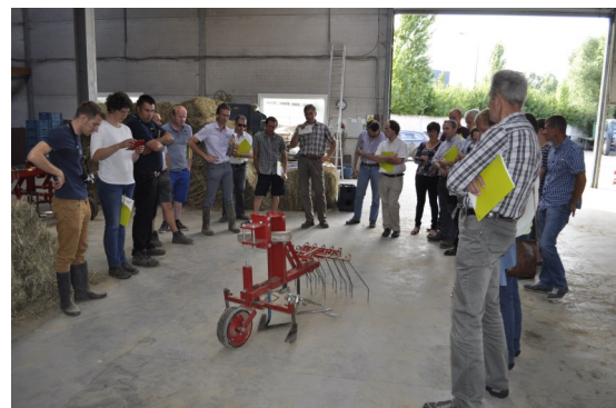
Foto 6: Thierry (achteraan) stelt zijn 'ideale' parallellogram voor: spelingsvrij, ruime aanbouwmogelijkheden, hoekschoffels, dubbel mes, torsiewieders en wiedegelementje.
