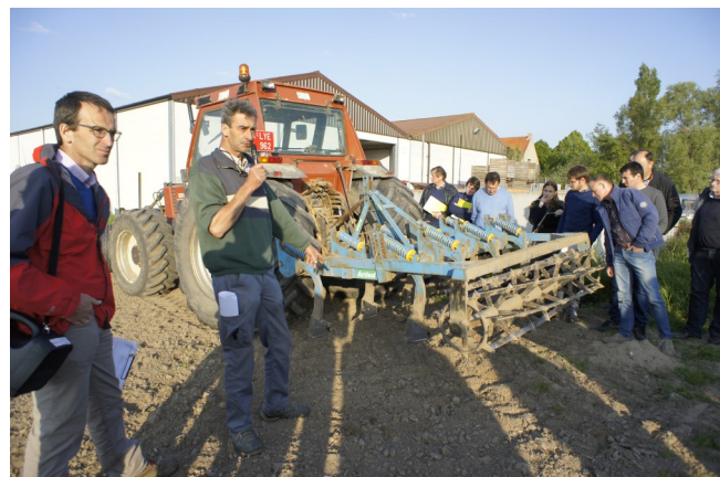
Foto 1: Jean-Pierre bewerkt zijn percelen sinds meer dan 10 jaar niet kerend met een Actisol om het bodemleven zo min mogelijk te storen. Het vernietigen van groenbemesters in het voorjaar is een uitdaging. Hiervoor gebruikt hij meestal een stoppelploeg.
