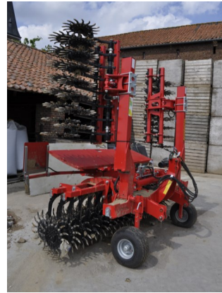
Foto 5: De 'houe rotative' is een een polyvalente machine die Pierre vaak afwisselend met de wiedege gebruikt. De pennen breken een eventuele korst mooi op en gooien klein onkruid los. Ook na opkomst is mooi werk mogelijk met slechts beperkte schade aan het gewas.
