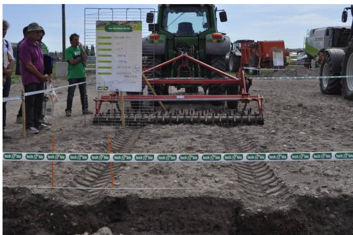
Figuur: Impact van bandbreedte en bandenspanning op bodemcompactie
