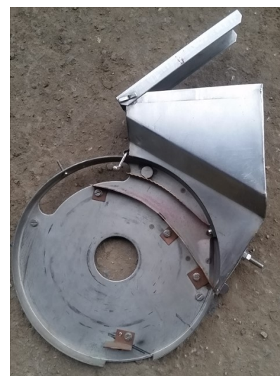
Foto 3. Bovenaan het zaadbakje met regelbare afstriker. Het plaatje onderaan strijkt de zaden van de zaaischijf zodat ze in de zaaigeul vallen.
