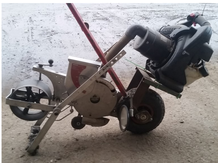
Foto 1. Zelfgebouwde pneumatische precisie zaaimachine, perfect door 1 persoon te hanteren. De opgebouwde 2-tact bladzuiger zorgt voor de onderdruk achter de zaaischijf. Het aandrukwieltje achteraan is afkomstig van een oude handzaaimachine. Het draaiknopje achteraan regelt de zaaidiepte. Met het spiegeltje aan de rechterzijde ziet de zaaier de zaden op de zaaischijf. Op het zaadbakje zie je de regelbare afstriker.
