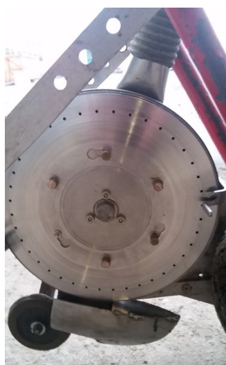
Foto 2. De verwisselbare zaaischijf, bovenaan de aansluiting met de vacuümmotor die onderdruk achter de zaaischijf creëert. Onderaan vallen de zaadjes van de schijf in de zaaigeul.
