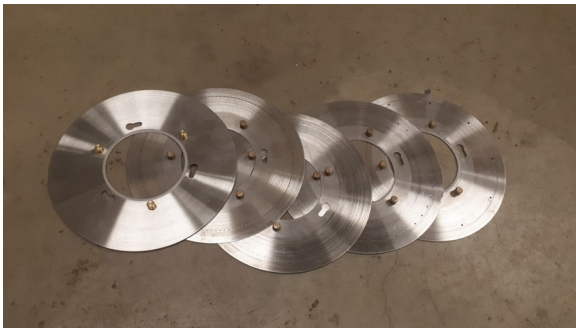
Foto 4. Zaaischijven met variatie in diameter van de gaatjes en aantal gaatjes per schijf.
