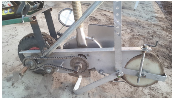
Foto 5. Met de eenvoudig verwisselbare tandwielen op die voorwielas en de as van het zaaielement regelen we de zaaiafstand in de rij. Een paar kettingen met verschillende lengte zorgen ervoor dat alle tandwielcombinaties mogelijk zijn van 15 tot 45 tanden.
